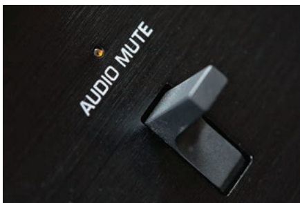
Hebelkowy układ szybkiego wyciszenia ustawia pokrętkę głośności w pozycji minimum.
