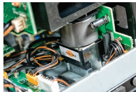
Potencjometr głośności pełni tylko rolę czujnika położenia...
