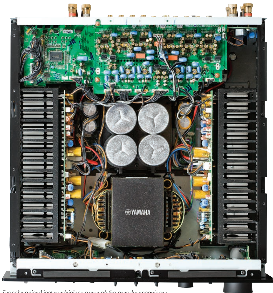
Sygnal z gniazd jest rozdzielany przez płytę przedwzmacniacza na dwa moduły końcówek mocy.
