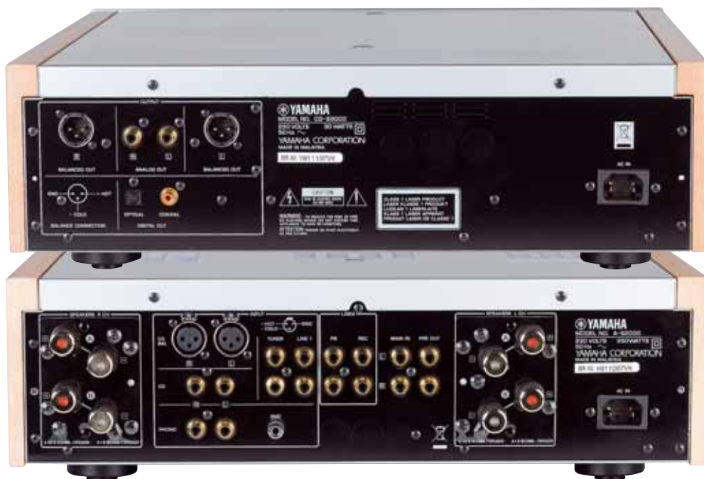
Die Rückseite zeigt die klassenüblichen Anschlüsse – lediglich der XLR-Ein- und Ausgang verraten die symmetrische Auslegung der Verstärkerstufen. An den Lautsprecherterminals des A-S2000 lässt sich problemlos Biwiring auch mit widerspenstigeren Kabeln realisieren
