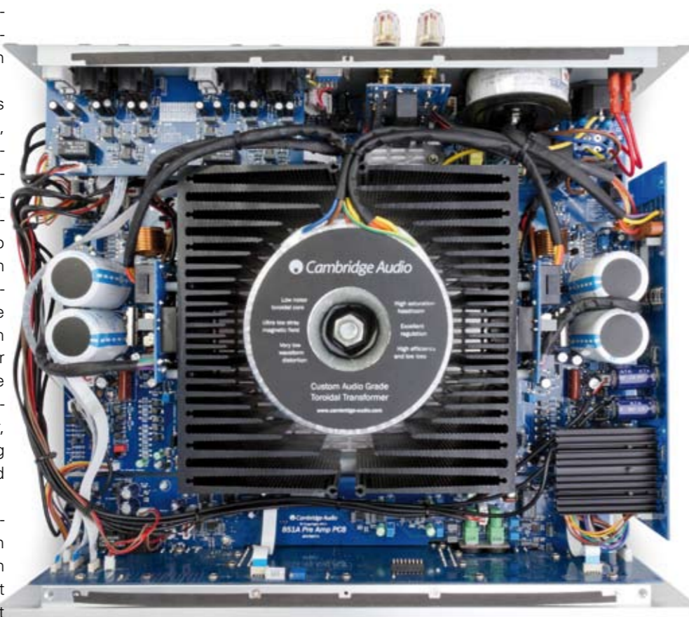
IM CAMBRIDGE, UM CABRIDGE: Die Engländer haben ihren Amp um den Haupttrafo und die massiven Endstufen-Kühlkörper herum aufgebaut. Dafür musste der Extra-Umspanner (1) für die IC-Eingangskreise ein Plätzchen auf der Rückwand und die zugehörige Stabi-Elektronik rechts außen unten suchen (2, darunter sitzt ein Standby-Kollege). Rechts und links bilden Gleichrichter (3), 15000-Mikrofarad-Elko-Stromspeicher (4), „Strom-Shift“- und jeweils vier Endtransistoren (SA1295/SC3264) kurze Stromkreise.
