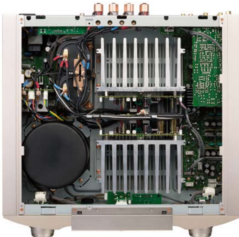
VIEL ALU FÜR WENIG SILIZIUM: An den riesigen Kühlkörper hängen nichts weiter als zwei relativ schmalbrüstige Sanken-Leistungstransistoren dran (plus ein Wärmefühl-Halbleiter). Für letztere liefern der abgeschirmte Ringkern-Netztrafo und die beiden Speicher-Gigant-Elkos (2 x 15000 Mikrofarad) mit Sicherheit Hafer genug. Bei den kleinen Stehplatinchen auf den größeren Boards handelt es sich um vorabgegliche Transistor-Verstärker-Einzelmodule, von denen Marantz offenbar gar nicht genug verbauen kann.
