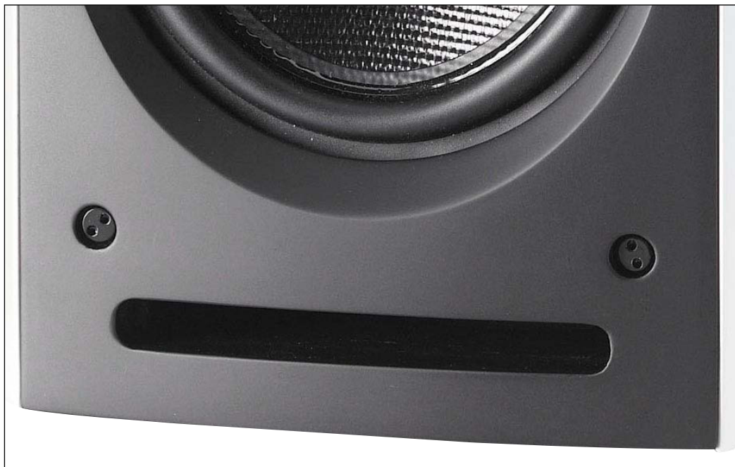
Schlitzstrahler: Statt eines runden Rohres kommt eine schmale Öffnung zum Einsatz. Das ist ästhetisch und erlaubt eine tiefe Abstimmung, begrenzt aber die Wirkfläche und birgt die Gefahr von Kompression.
