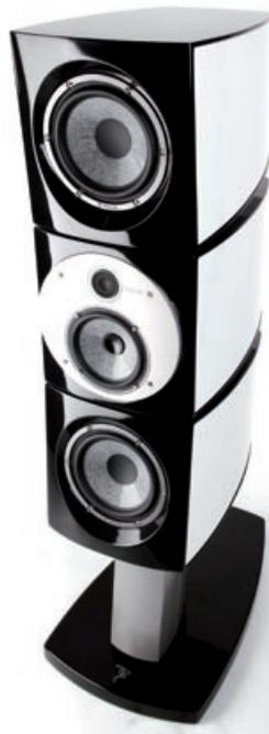
Der Viva-Korpus besteht aus drei Teilen, die so angeordnet sind, dass Bass- und Mittelhochtonsignale zeitgleich am Ohr des Hörers ankommen. Neben dem stabilen Anschlussfeld auf der Rückseite finden sich zwei kleine Schlitze: mit Schaumstoff verschlossene Öffnungen, sogenannte Fließwiderstände, die dem Mitteltöner ein größeres Volumen vorgaukeln und seine Impedanz senken. Der passende (mit Sand gefüllte) Ständer ist 40 cm hoch, wiegt 23 Kilogramm und kostet 875 Euro pro Stück zusätzlich.
