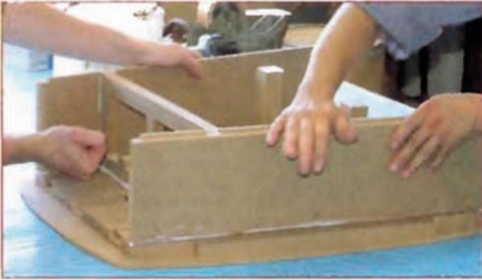
Un véritable travail d'ébéniste d'art que l'assemblage des différentes parois formant ici le coffret indépendant de la charge médium de la Scala. Bien visibles les nombreux renforts internes ainsi que l'assemblage mécanique par rainures et mortaises des parois perpendiculaires avec collage.
