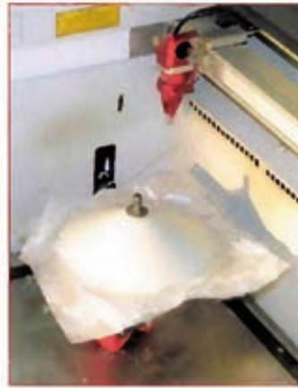
Découpe de très haute précision de la membrane sandwich W par laser. Parfaite reproductibilité des circonférences d'une membrane à l'autre pour le bord extérieur de la membrane d'un côté et le support de bobine de l'autre.
