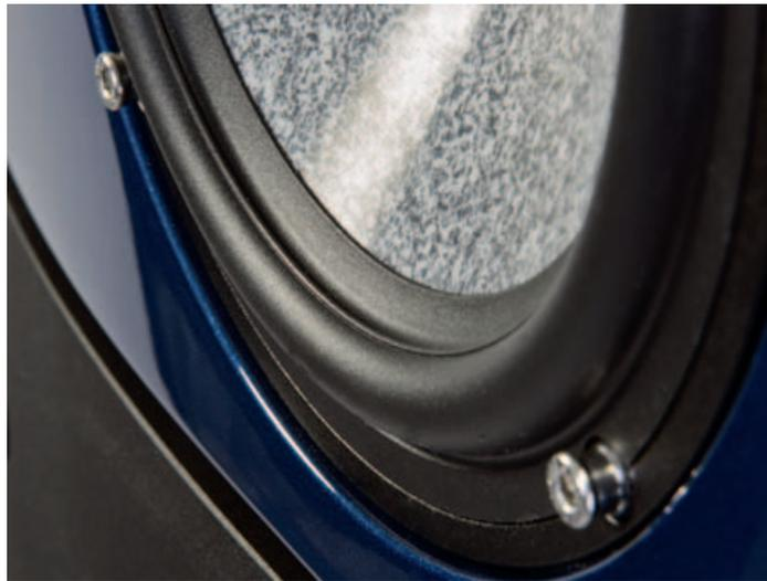
Die Sicke trägt einen kaum sichtbaren Gummiring, einen Massedämpfer, der das unkontrollierte Ausschwingen und Resonieren des weichen Gummis effektiv verhindert.
