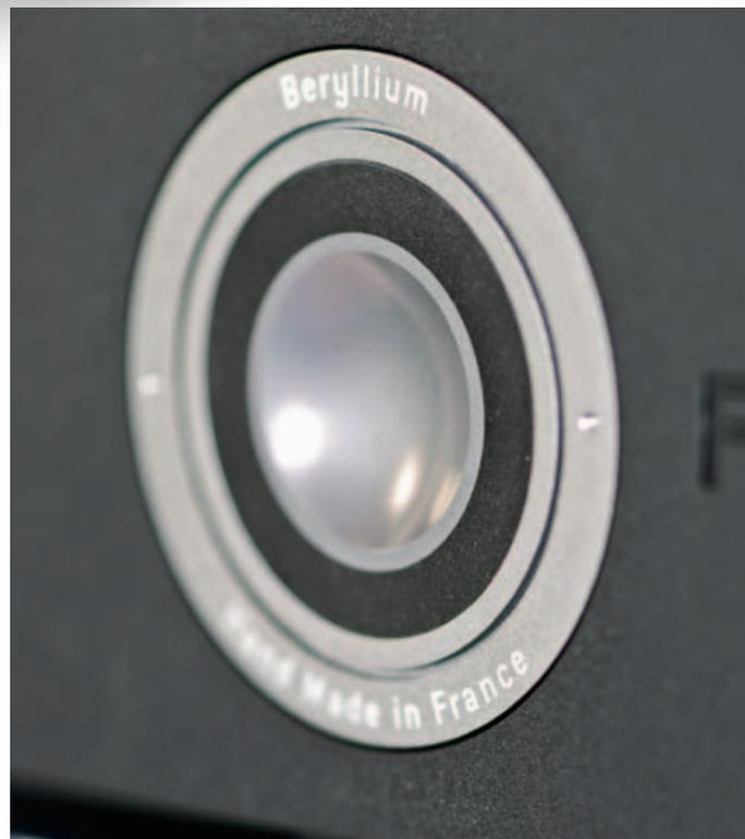
Die schaumgummigelagerte Inverskalotte besteht aus dem Leichtmetall Beryllium, das einen idealen Kompromiss zwischen Steifigkeit, innerer Dämpfung und Vermeidung von Eigenresonanzen bietet.
