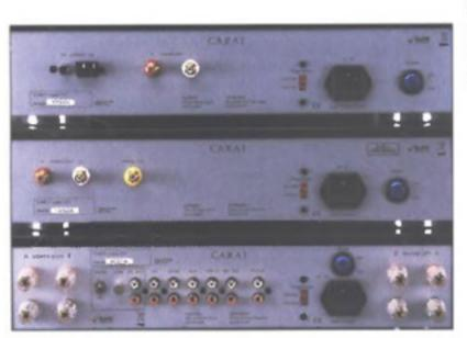
Les connexions sont clairement repérées. Sur l'ampli (en bas) l'entrée phono avec sa prise de terre et l'inverseur MM/MC a droit à sa cartouche de repérage. Les ronds bleus sont les interrupteurs de mise hors tension secteur totale.
