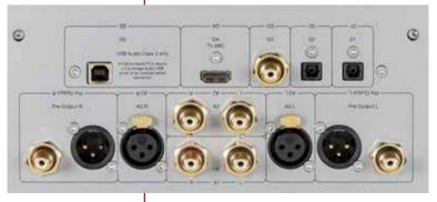
Die stabilen Signalanschlüsse offenbaren den symmetrischen Doppel-Mono-Aufbau des Edge A.
