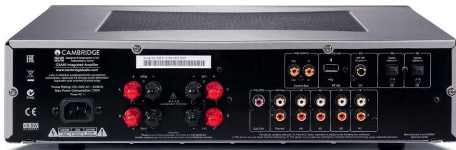
**ANSCHLUSSFELD:** Das Wichtigste ist vorhanden – vier analoge Cinch-Paare und dreimal S/PDIF. Der USB-Port ist ausschließlich für den optionalen Bluetooth-Adapter gedacht.
