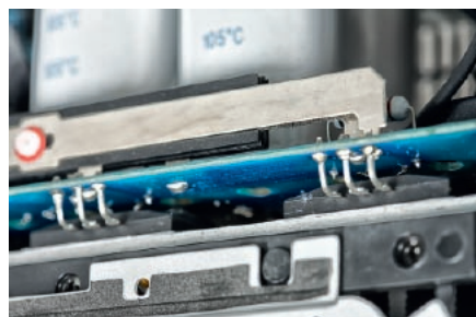
Potężne tranzystory Sanken – już nieprodukowane, a szkoda.
