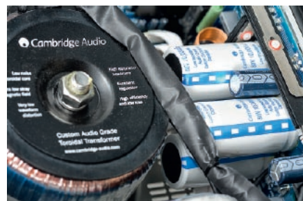
Zasilacze wraz z kondensatorami filtrującymi zamontowano na płytkach z końcówkami, tuż przy układach, których dotyczą.
