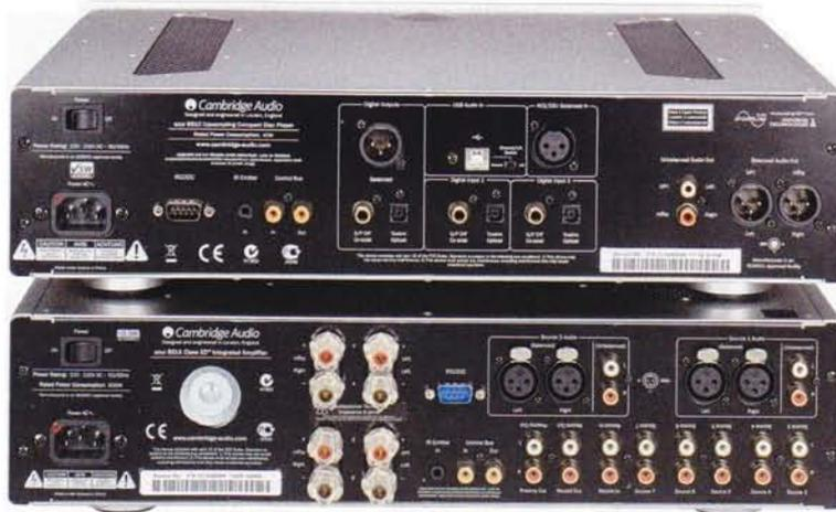
Der hohe Anspruch der Geräteklasse wird nicht zuletzt durch die symmetrischen Anschlüsse offensichtlich. Eine deutliche Aufrüstung gegenüber der 840er-Generation stellt der HD-fähige USB-Port für Mac/PC dar. Die hochwertige DAC-Sektion steht auch anderen Quellgeräten zur Verfügung
