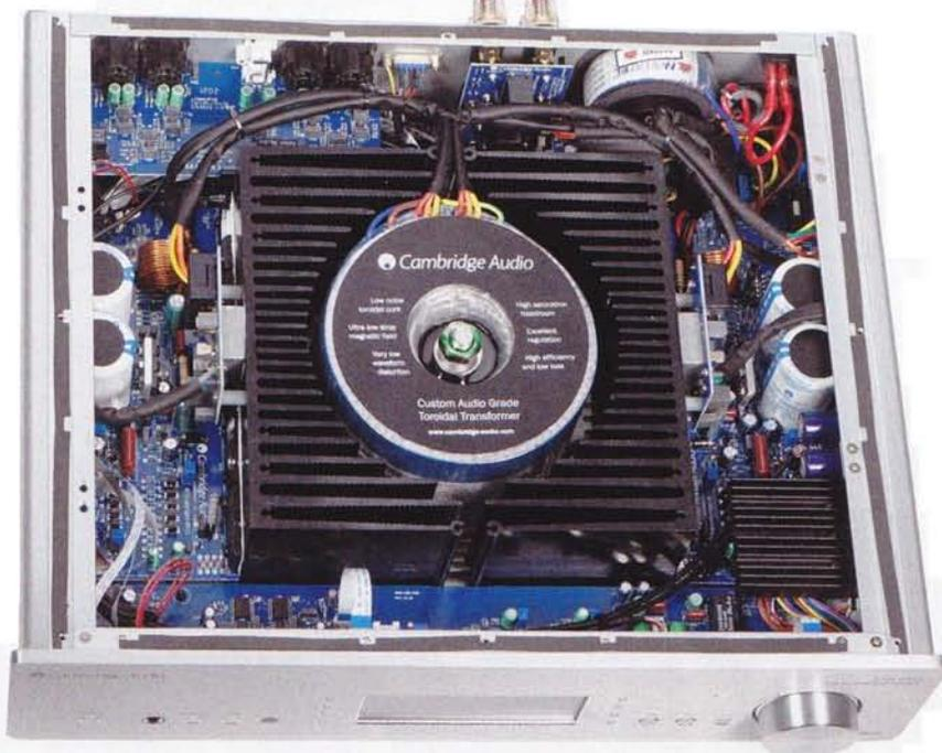
Die Architektur des Cambridge-Verstärkers ist ausgefuchst, denn sie gewährleistet die angestrebte räumliche Trennung von Vor- und Endstufe, separiert beide Kanäle, zentralisiert dabei die Stromversorgung und schirmt zugleich den Trafo ab
