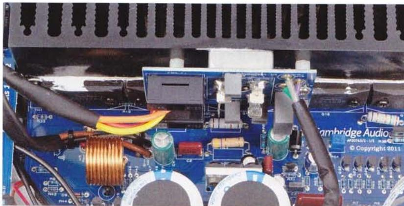
Der tiefere Blick auf die Motorisierung offenbart den Einsatz japanischer Sanken-Transistoren des bipolaren Typs, die einen besonders guten Ruf genießen. Auch die für die Impuls wiedergabe wichtige Siebkapazität (die weißen Kondensatoren) ist großzügig ausgelegt
