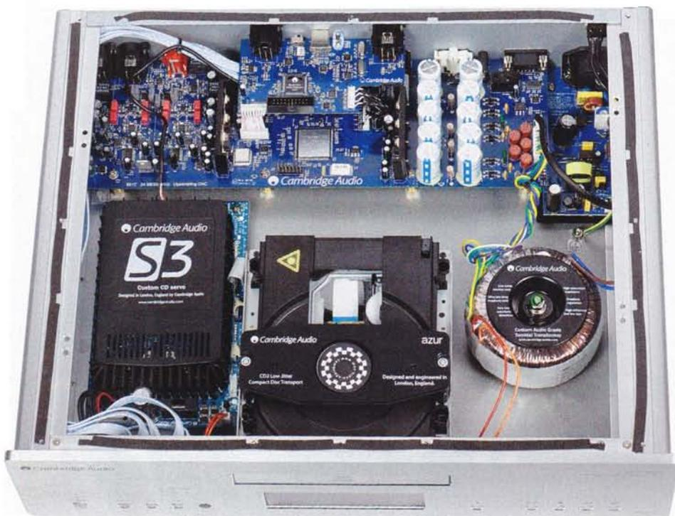
Für einen CD-Spieler diesseits der 2000-Euro-Brandmauer ist der Cambridge sehr massiv gebaut und besitzt zudem eine Top-Servo-Steuerung sowie einen üppigen Ringkerntrafo
