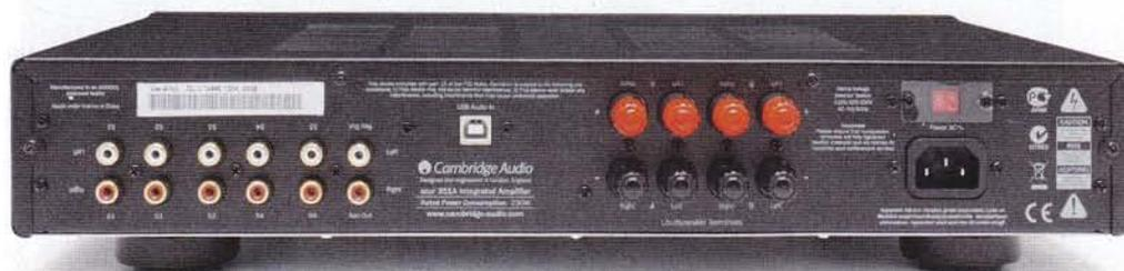
110/220-Volt-Umschaltung (rechts). Vergoldete Cinch-Buchsen und ein serienmäßiger USB-Eingang, der digitale Signale bis 16 Bit / 48 kHz entgegennimmt.
