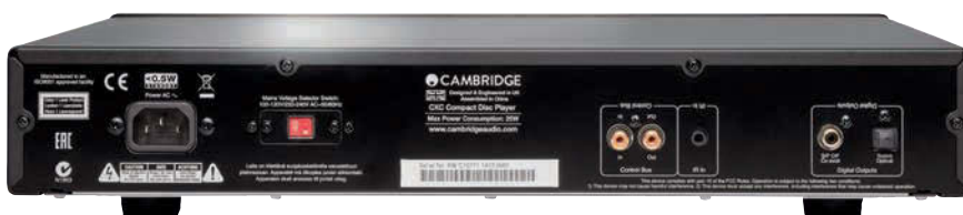
Beim reinen Laufwerk oder „Transport“ sparte sich Cambridge Audio den redundanten Wandler samt Analoganschlüssen und verbesserte stattdessen lieber die aufwendige Laufwerkssteuerung.
